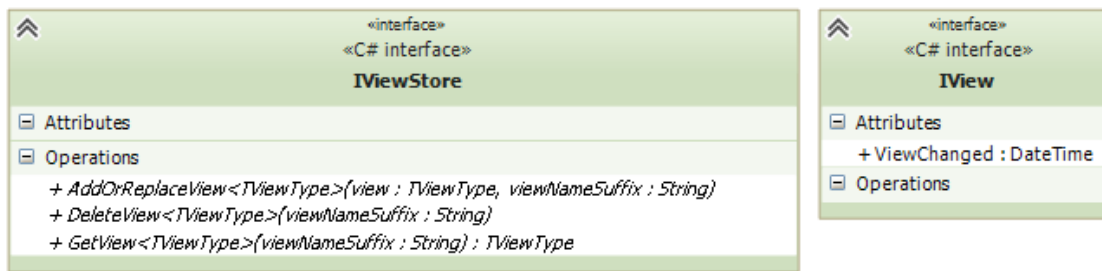
Abbildung 5.15.: UML-Diagramm des View Store Interface
